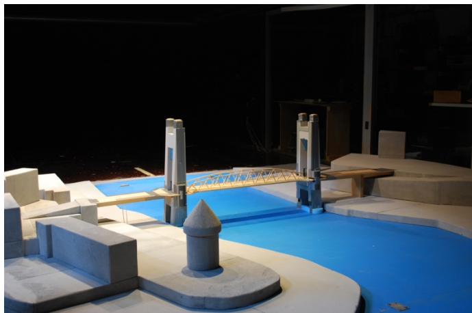
Etude aérodynamique du nouveau Pont de recouvrance en soufflerie (CSTB)
